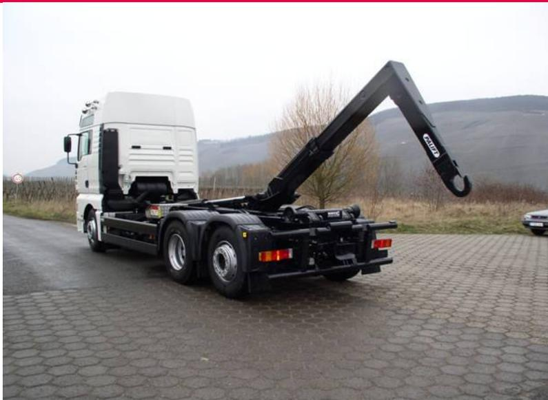
Il 311PH è sempre da ordinare per scarrabili a rulli senza caricatore. Infatti all'inserimento della presa di forza per scarrare o caricare, le sospensioni si devono abbassare fino a ca. 20 mm dal tampone (ca. 60 mm sotto il livello di marcia).
